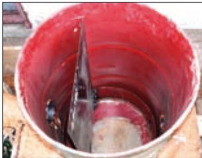
Bild 7: Blick in den im Bau befindlichen Ascheabscheider
