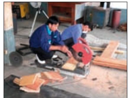
Bild 12: Kein Augen- oder Gehörschutz – aber immerhin mit Atemschutz
